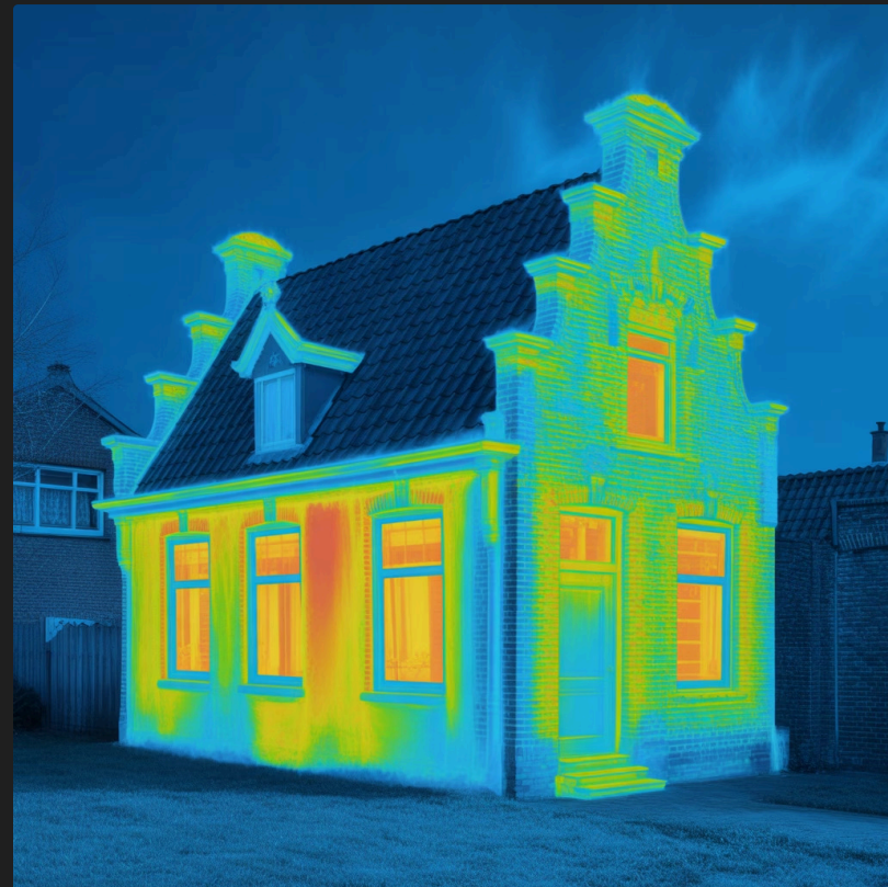
Warmtebeeld van een slecht geïsoleerde woning met energielabel G
